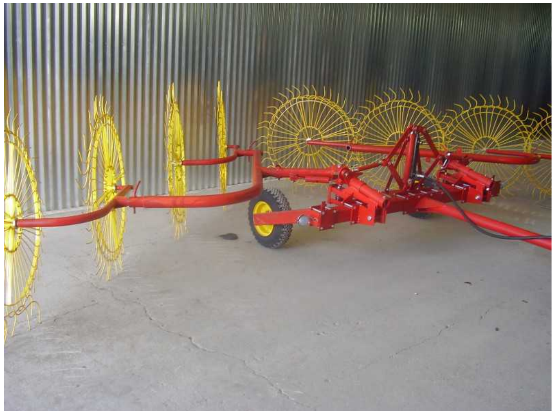
Рис. 3.3. Установка секций граблей на ворошение
