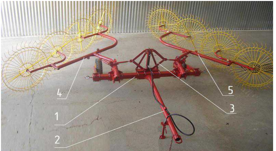
Рис.3.2. Установка секций граблей на сгребание 1-Балка, 2-Сцепка, 3-Механизм подъема секций, 4-секция правая, 5-секция левая.
