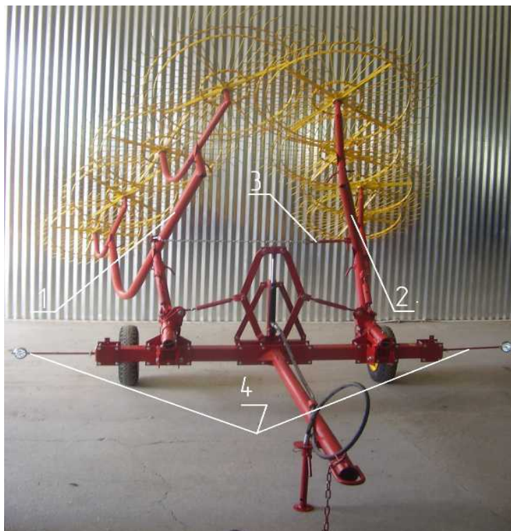
Рис. 3.4. Схема транспортировки граблей
